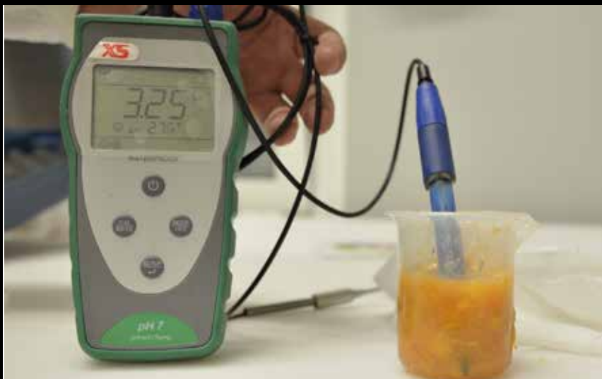
43. Strumenti per la misurazione del pH
