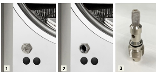
1 2 3 Filtre situé dans la partie inférieure avant, derrière la porte.
