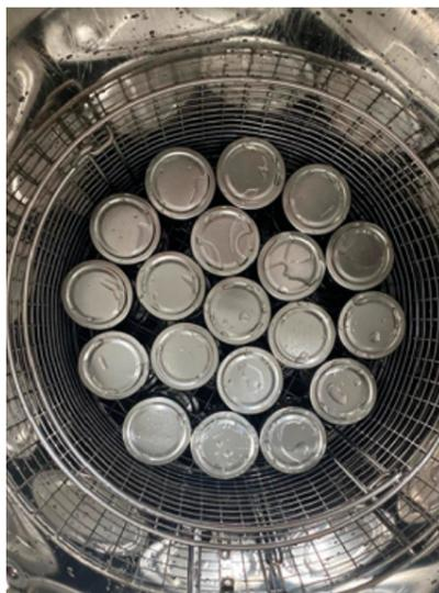
Una volta terminato il ciclo di sterilizzazione o pastorizzazione, inizia il ciclo di raffreddamento rapido, che abbassa la temperatura attraverso un sistema di doccia e immersione in acqua.
