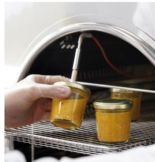
Utilizzando una sonda di temperatura posta all'interno di un campione di prodotto, garantiamo un perfetto controllo del processo, preservandone le proprietà organolettiche e riducendo al minimo le possibili variazioni del valore nutritivo del prodotto confezionato.
