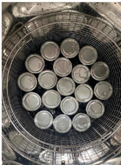
Une fois le cycle de stérilisation ou de pasteurisation terminé, le cycle de refroidissement rapide commence pour abaisser la température moyenne grâce à un système de douche et d'immersion dans l'eau.
