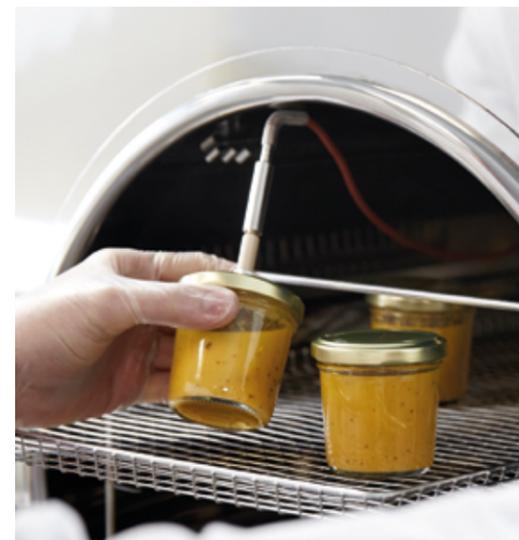
Une sonde de température située à l'intérieur d'un échantillon de produit assure le contrôle parfait du processus, en conservant les propriétés organoleptiques et en minimisant les éventuelles modifications des valeurs nutritionnelles du produit conditionné.
