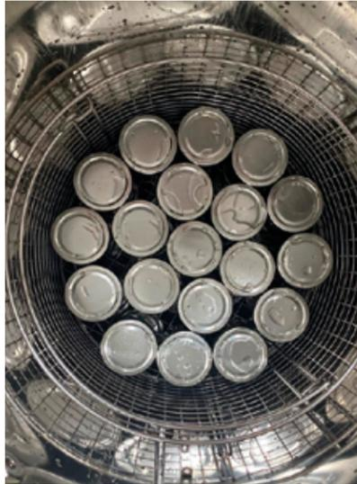
Sobald der Sterilisations- oder Pasteurierungszyklus abgeschlossen ist, beginnt der Schnellabkühlungszyklus, der die Temperatur mit Hilfe eines Dusch- und Wassertauchsystems senkt.
