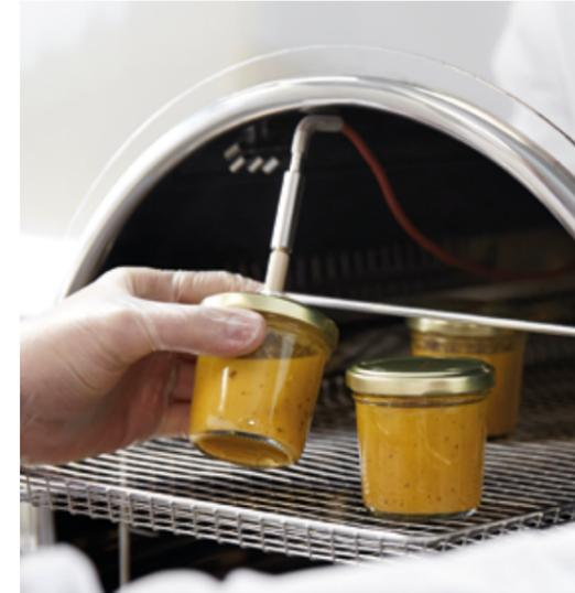
Durch den Einsatz einer Temperatursonde, die im Inneren einer Produktprobe platziert wird, eine perfekte Kontrolle des Prozesses gewährleistet, wobei die organoleptischen Eigenschaften erhalten bleiben und mögliche Veränderungen des Nährwerts des verpackten Produkts minimiert werden.
