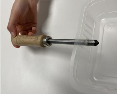
1. Avec le poinçon, perforer le récipient semi-rigide de l'échantillon.
