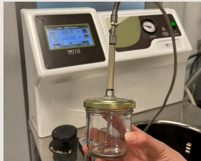
5. Placer un joint torique à l'extrémité du séparateur en plastique, puis **visser le récipient de l'échantillon à la sonde de température centrale\*** de l'autoclave.
