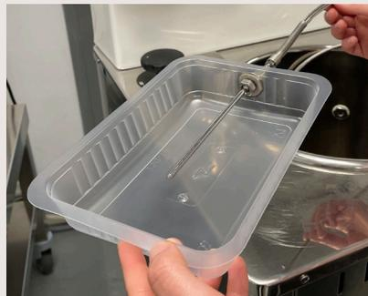
5. Finalement, à l'extrémité du puits thermométrique\*, visser le récipient de l'échantillon à la sonde centrale\*\* de l'autoclave.
