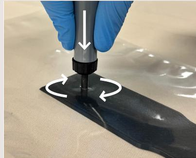
2. Exercer une pression avec le poinçon et le faire tourner sur la spatule en plastique pour perforer le sachet d'un côté.
