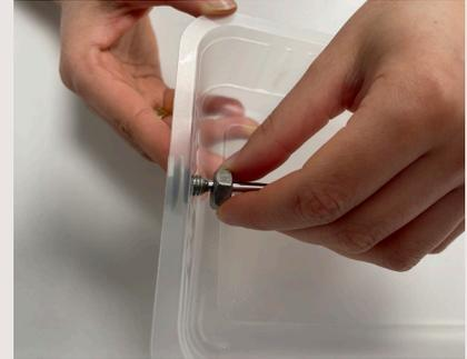
3. À l'intérieur du récipient de l'échantillon, visser l'écrou sur le puits thermométrique.
