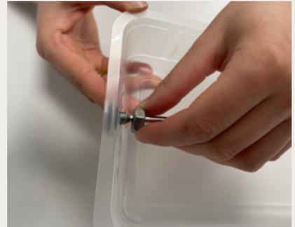
3. Schrauben Sie die Mutter im Inneren des Probenbehälters auf die Tauchhülse.
