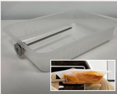
4. Versiegeln Sie den bereits durchstochenen Probenbehälter mit dem Produkt darin.
