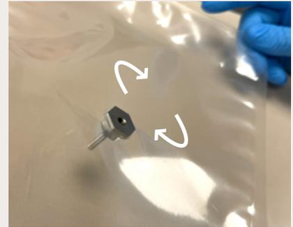
3. Den Schutzrohr mit der O-Ring Ø7 mm in die Öffnung einsetzen und durch Drehen das Einführen erleichtern. Im Inneren die Silikondichtung einsetzen und die Mutter aufschrauben.
