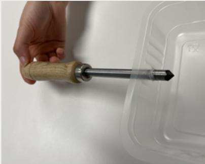
1. Verwenden Sie den Bohrer, um den halbstarren Probenbehälter zu durchstoßen.
