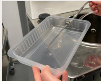
5. Schließlich schrauben Sie den Probenbehälter am Ende der Tauchhülse\* **an den Kerntemperaturfühler\*\*** des Autoklaven.
