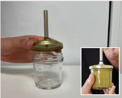
4. Verschließen Sie den bereits durchstochenen Deckel mit dem Produkt im Inneren des Probenbehälters.
