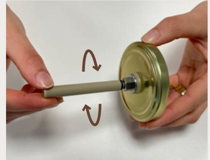
3. Schrauben Sie das Distanzstück auf die Bohrmutter, legen Sie zuvor einen O-Ring so ein, dass er sich zwischen dem Kunststoff-Distanzstück und der Bohrmutter befindet.
