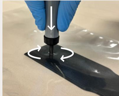
2. Druck auf den Bohrer ausüben und ihn auf dem Kunststoffspatel drehen, um den Beutel auf einer Seite zu perforieren.
