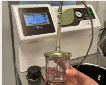
5. Platzieren Sie einen O-Ring nach dem Kunststoff-Abstandshalter und schrauben Sie **schließlich den Probenbehälter auf den Temperaturkernfühler\*** des Autoklaven.
