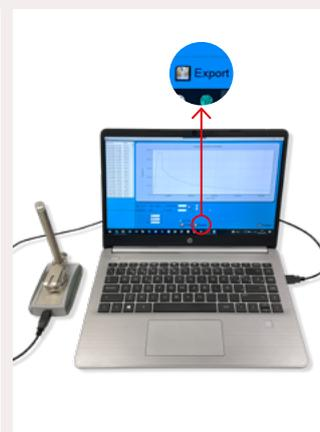
**4.** À la fin du cycle, retirez l'enregistreur de l'échantillon et insérez-le à nouveau dans la base de connexion raccordée à un PC. Par le biais du logiciel, visualisez à l'écran et/ou exportez les données obtenues pour le cycle.
