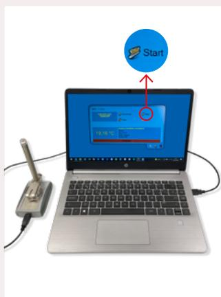
**1.** Une fois l'enregistreur placé sur la base de connexion et celle-ci connectée à un PC, commencez l'enregistrement des données en cliquant sur « Start » dans le logiciel, téléchargeable gratuitement.
